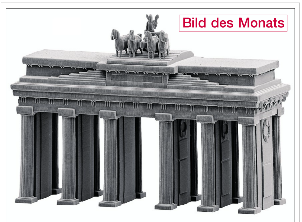
WIEDERERKENNBAR: Trotz seines Nanometerformats ist das von einem 3-D-Laserlithografiegerät hergestellte Brandenburgertor als das berühmte Baudenkmal in Berlin zu erkennen. Im Original ist das Objekt kleiner als ein Haar breit ist. Foto: Nanoscribe
